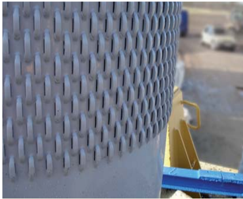
Brunnenrohr mit Filteröffnungen (oben) und Vollrohrabschnitt (unten)
