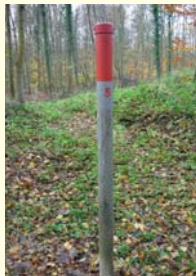
Tassenpegel innerhalb eines Rückhalteriums zur Messung der Flutungshöhe
